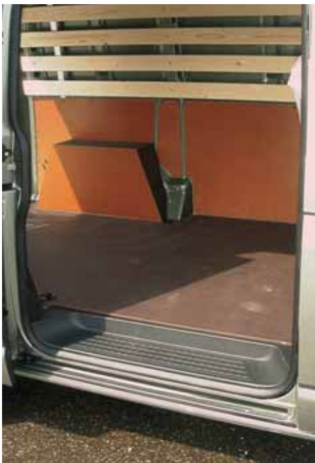
Wandbekleding en vloerplaten
